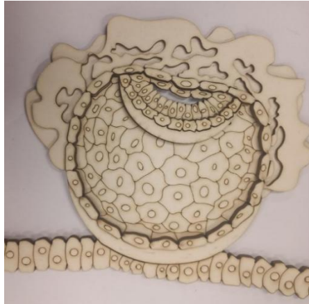
Figura 6. Cuarto prototipo obtenido por corte láser en material de gris pardo con el objetivo de probar texturas, cantidad de capas y espaciado de los elementos
