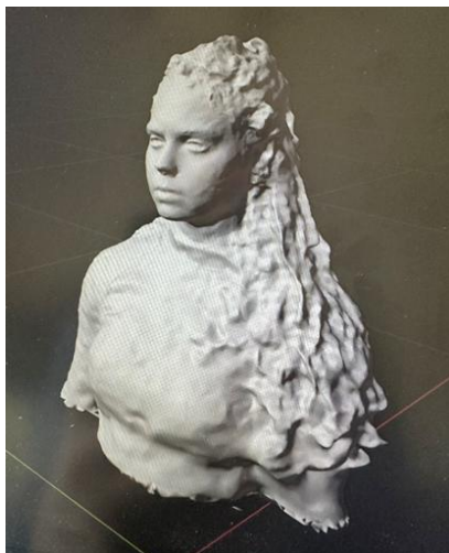
Fig. 1. Detalle de la digitalización realizada y la corrección de la malla en el software de edición 3D Blender® (captura de pantalla del modelado 3D de la modelo digitalizada).
